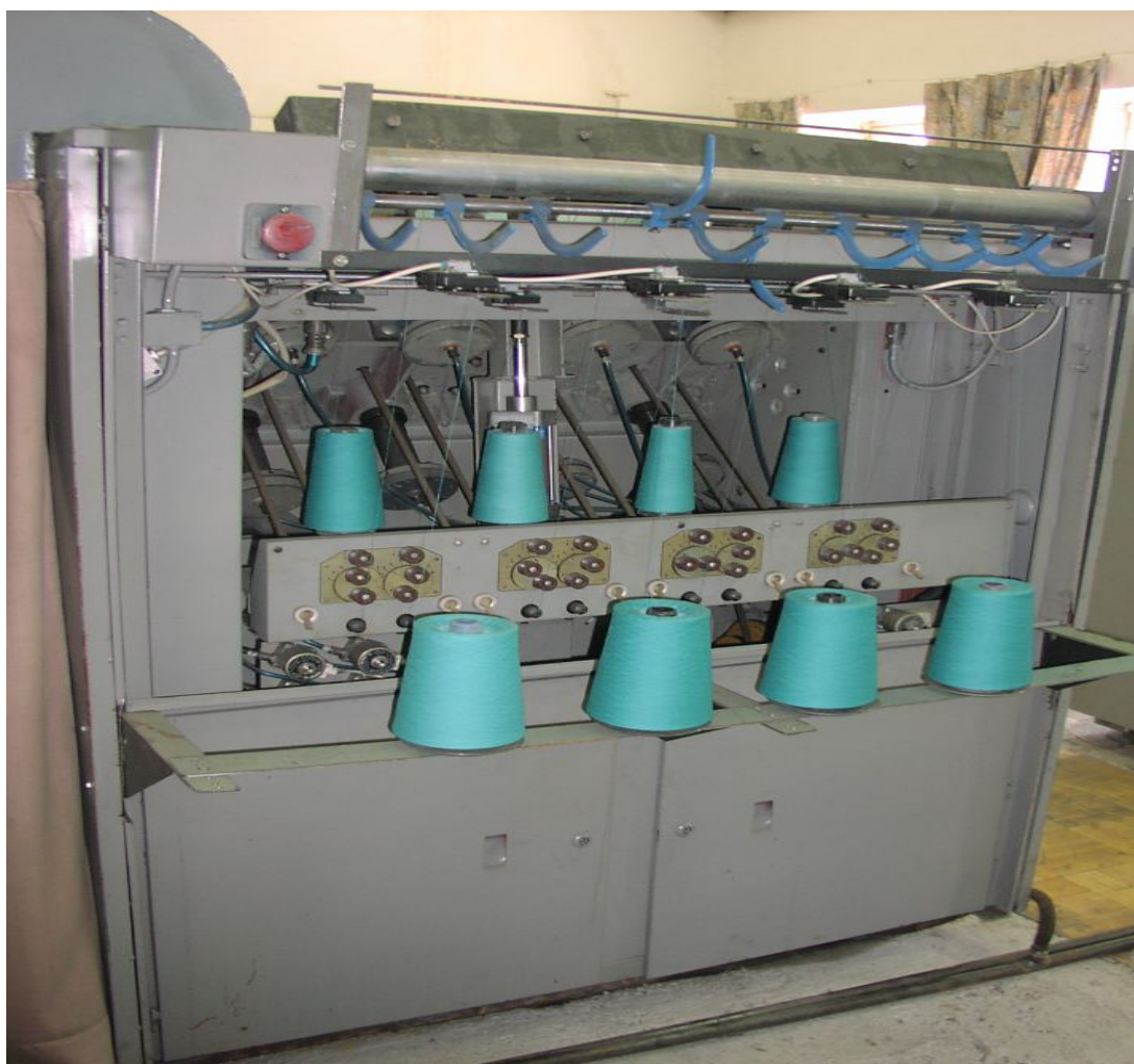
Рис. 5. Узел питания исходными нитями (пряжей).
