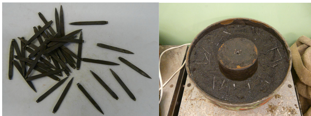
Рис.4. Экспериментальные исследования влияния параметров виброобработки на шероховатость колков
