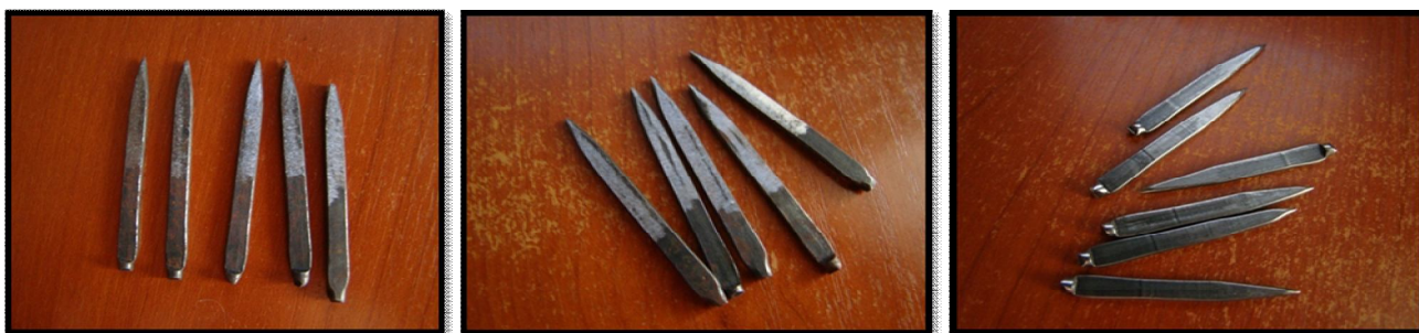
Рис.5. Образцы колков с различной шероховатостью Ra 0.8...5.6 мкм
